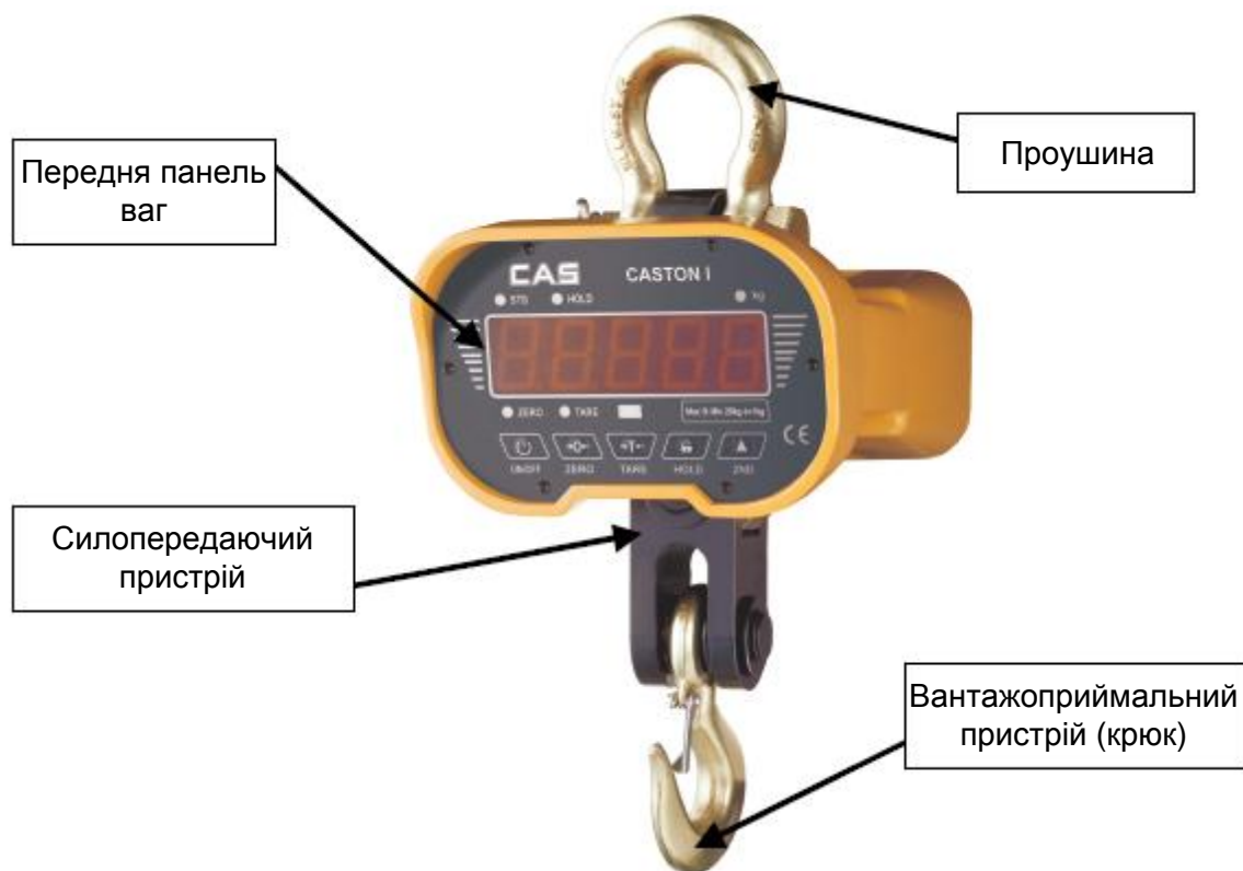
Рис.1. Загальний вигляд ваг і позначення основних елементів
